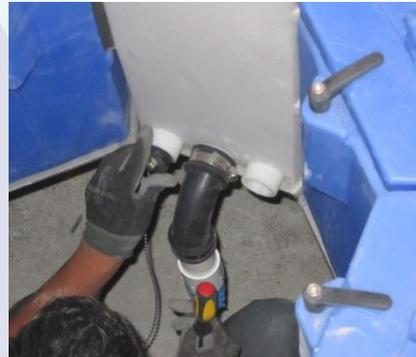
6- Una vez terminado este proceso se debe volver a colocar las matalas (ya sean nuevas o lavadas) y los medios filtrantes remplazados.
