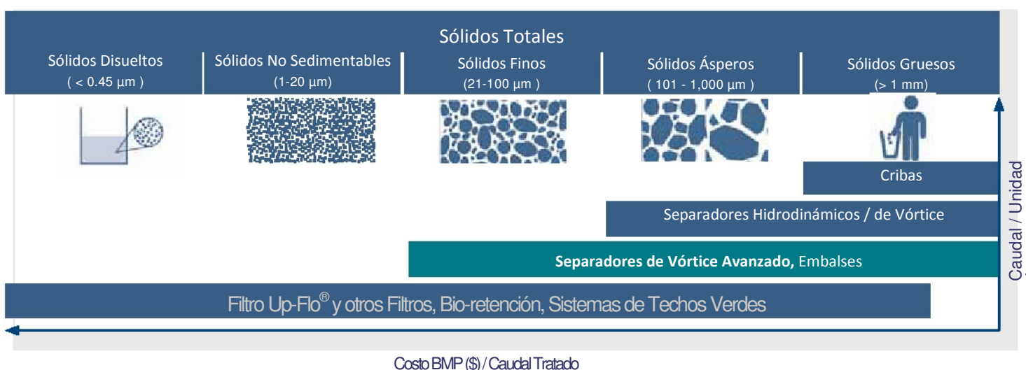
Ilust.2 Los Separadores de Vórtice Avanzado permiten tratar una variedad del espectro de Sólidos Totales más amplia que los separadores de vórtice e hidrodinámicos convencionales
