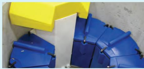
El **Filtro de Flujo Ascendente Up-Flo®** es un sistema de tratamiento pluvial de lecho fluidizado por etapas, que ofrece elevadas tasas de filtrado así como una mayor vida útil de los medios filtrantes. El **Filtro Up-Flo®** retira del escurrimiento pluvial materia orgánica, metales, hidrocarburos, basura y nutrientes, con una capacidad de remoción del 90% para partículas mayores a 20 micras. Es un filtro muy eficiente que funciona con la fuerza del agua y de fácil mantenimiento.
